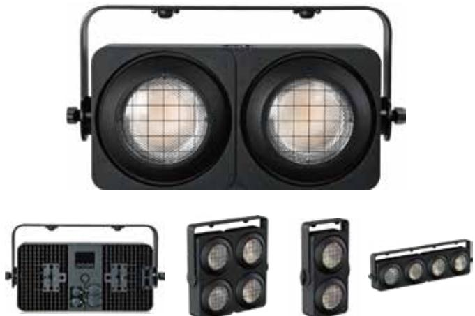
**BLINDER-II-IP**は ウォームホワイトとアンバーのCOB LEDを組み合わせた147Wのバイカラー光源を搭載。最大10,556ルーメンの高出力を実現しました。演色性CRI92.4の高品質な光は、ステージ演出やイベント照明において自然で美しい肌色を再現します。ビーム角58.8°、フィールド角98.1°の広範囲照射が可能。2750Kの色温度が安定した温かみのあるトーンを提供します。ファンレス設計ですので静音性が求められる現場でも安心して使用できます。
